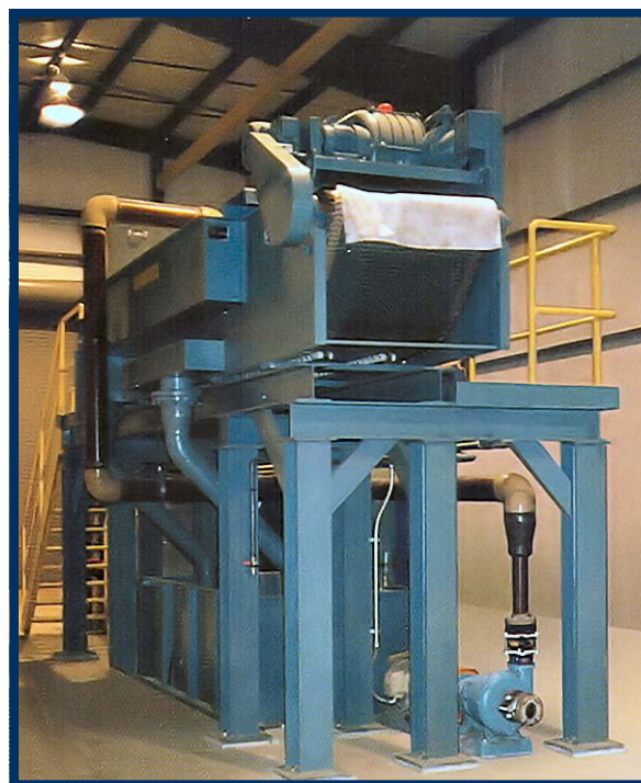
Dans l'usine d'un client, le F-750 assure le filtrage d'eau contaminée provenant du bac de condensat d'un broyeur
