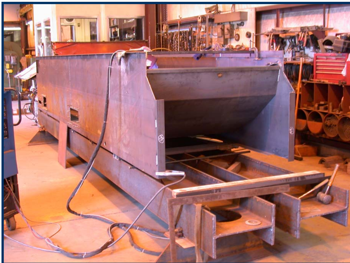
Fabrication de la cuve du filtre standard Vacu-Matic F1000 pour une utilisation avec un laminoir d'aluminium
