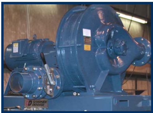
Ventilateur aspirant 4203A Gardner Denver et moteur 20 HP sur un filtre Vac-1000
